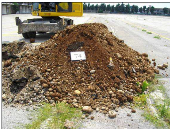
Cumulo di materiale riferibile all'Unità Rp (0.00 – 1.70 m).
