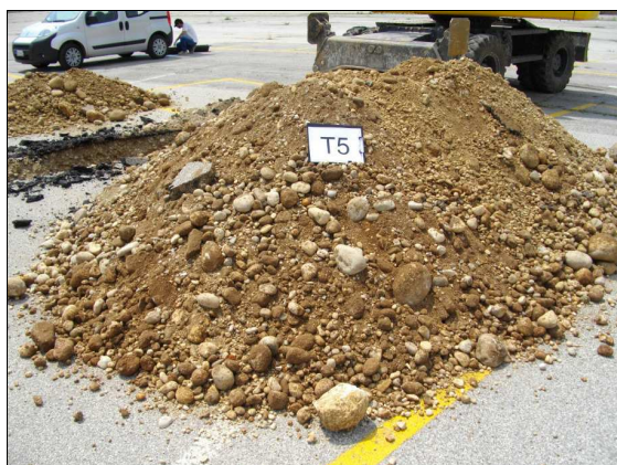
Cumulo di materiale riferibile all'Unità Rp (0.00 – 1.60 m).
