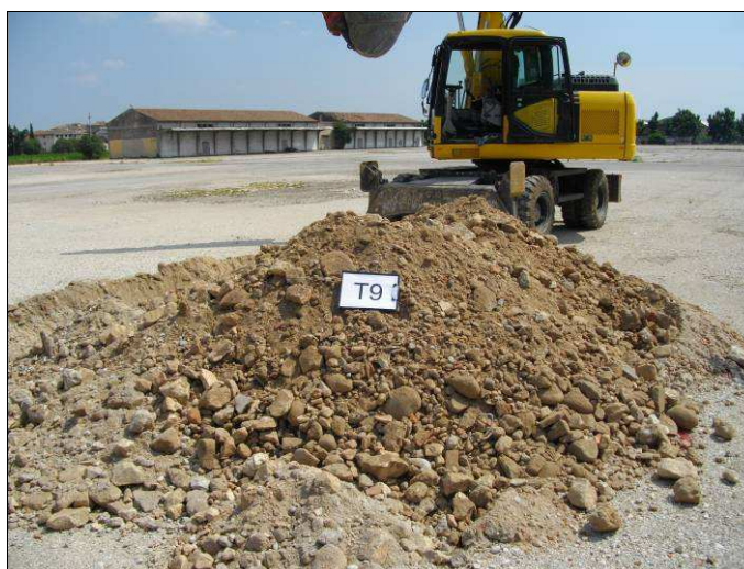
Cumulo di materiale riferibile all'Unità Rp (0.00 – 3.00 m).
