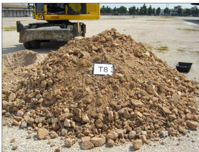
Cumulo di materiale riferibile all'Unità Rp (0.00 – 3.10 m).
