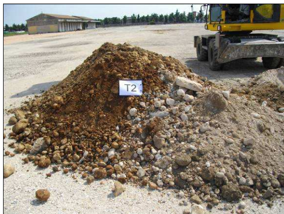
Cumulo di materiale riferibile all'Unità Rp (0.00 – 2.50 m).
