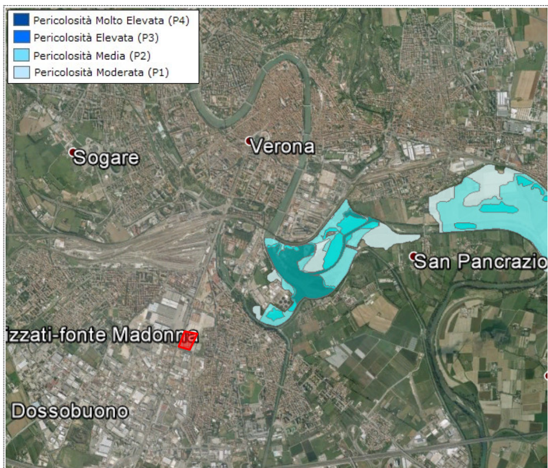
Fig. 10_ Estratto della "Carta della pericolosità idraulica" del P.A.I. del Fiume Adige. Le aree colorate indicano le zone soggette a pericolosità idraulica; la variazione dal celeste chiaro al blu scuro indica un aumento della pericolosità. In rosso il lotto di interesse progettuale.
