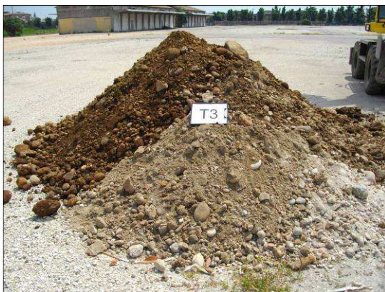
Cumulo di materiale riferibile all'Unità Rp (0.00 – 2.70 m).
