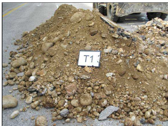
Cumulo di materiale riferibile all'Unità Rp (0.00 – 1.00 m).
