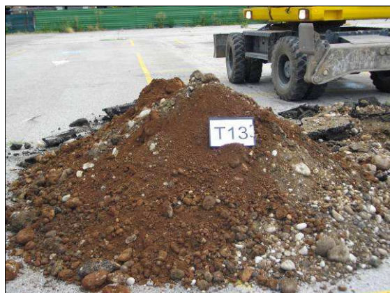
Cumulo di materiale riferibile all'Unità Rp (0.00 – 1.50 m).
