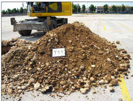
Cumulo di materiale riferibile all'Unità Rp (0.00 – 1.80 m).
