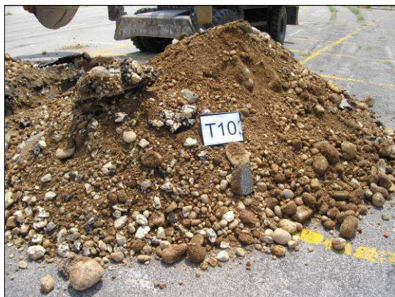
Cumulo di materiale riferibile all'Unità Rp (0.00 – 1.60 m).
